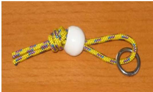
Un anneau de cargue de spi (avec garcette 0,2 m diam 2,5mm et boule d'arrêt spécifique) se positionne sur le patch le plus bas du spi.
