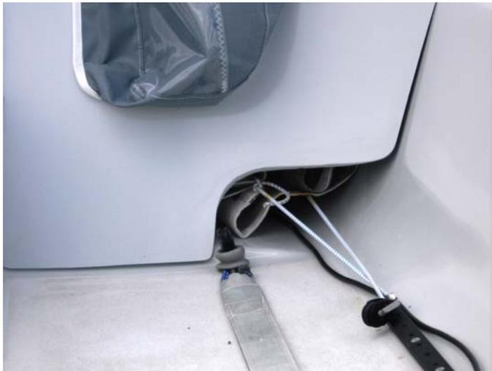
La poulie de cargue doit être fixée sur le trou avant du rail de foc tribord grâce à un pontet œil qui sera posé avec une vis diam4 longueur 16mm et un écrou M4 (glissé dans le rail).
