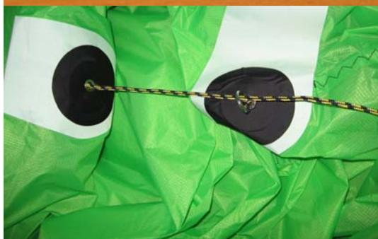
L'anneau facilite un meilleur coulissement de la cargue. La drisse ne doit donc plus traverser le spi dans le patch du bas.
