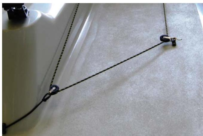
Une poulie complète le circuit de cargue de spi afin de dégager la cargue des pieds de l'équipier. Cette poulie est fixée sur la fixation centrale de la sangle de rappel.
