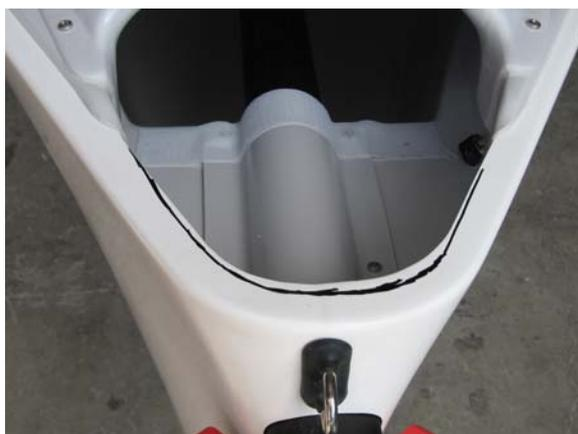
Egalement sur les premiers bateaux, le retour du livet au niveau de l'avaleur est diminué par découpe ou ponçage. Le bord doit être rayonné avec de l'abrasif grain 100 puis 220 maxi. Il est recommandé d'utiliser régulièrement un vaporisateur
